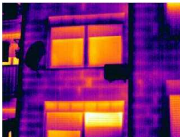
Slika 2.: Slaba toplinska izolacija vanjskog zida, prozora i kutije za rolete je uočljiva. Pri proračunu potrebno je koristiti korigirane, odnosno povećane koeficijente prolaza topline i zida i prozora od onih koji su navedeni u projektnoj dokumentaciji.
